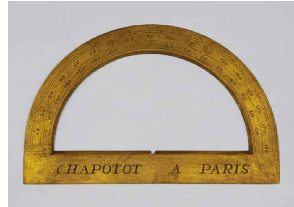
4. Demi-cercle gradué Alliage de cuivre doré. XVII e siècle Fabriquée à Paris 11,5 x 7,2 cm Musée du Palais de la Cité interdite, Pékin
